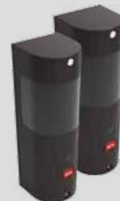
Paire de cellules photo-électriques sans fils, avec possibilité de gestion d'un bord sensible actif à infrarouge ou résistance. Possibilité d'orienter le faisceau de 180° horizontalement et 20° verticalement. Portée 30 m. Alimentation 24 Vca/Vcc
